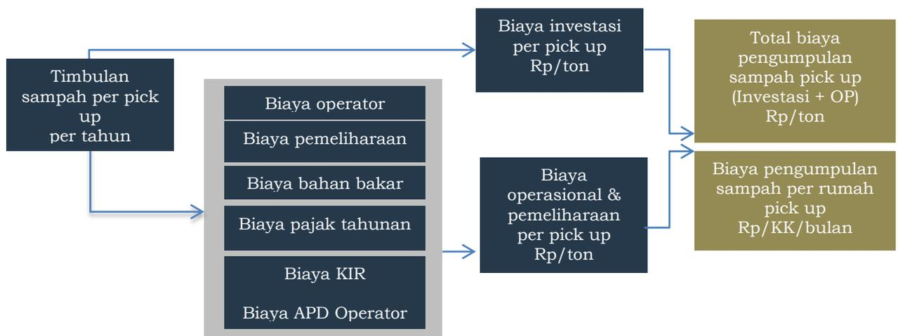
Gambar 2.3 Diagram Alir Perhitungan Biaya Pengumpulan Sampah dengan Pick Up
