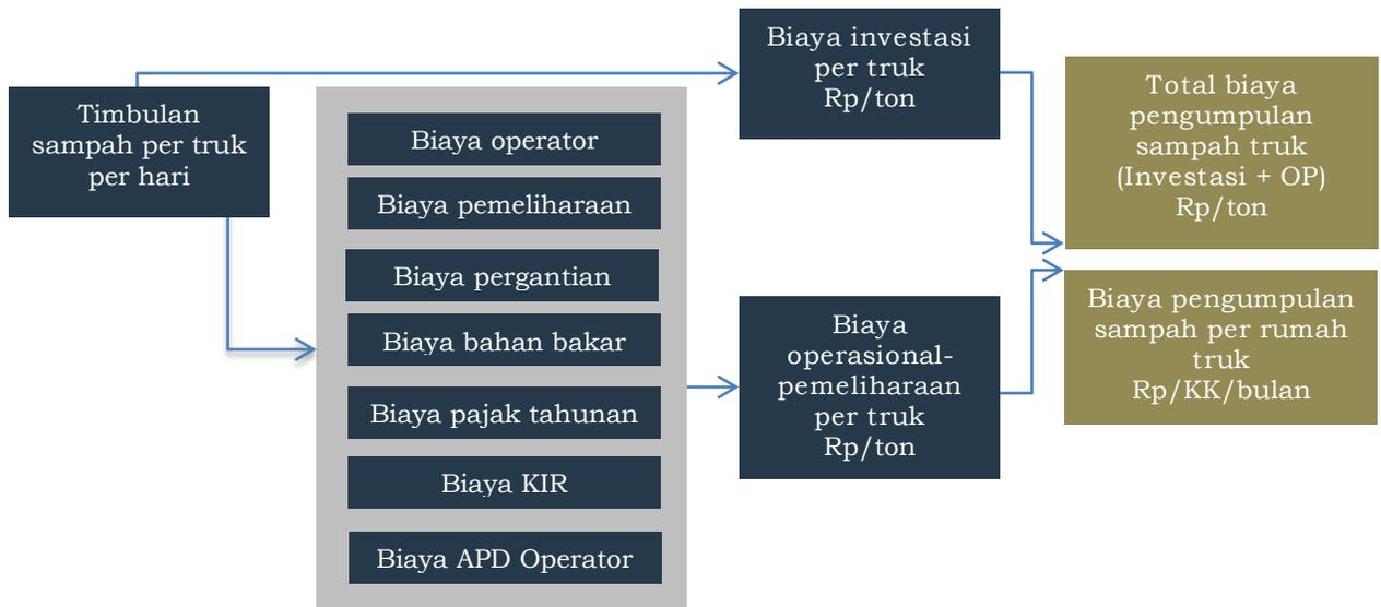
Gambar 4.1 Diagram Alir Perhitungan Biaya Pengangkutan Sampah dengan Truk
